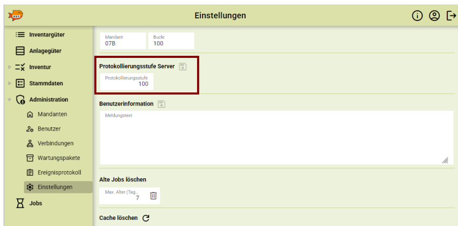
Abbildung 5-2 Einstellen Protokollierungsstufe Server
